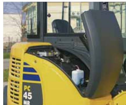
Capac de vizitare in partea din fata pentru alimentarea rezervorului de combustibil
